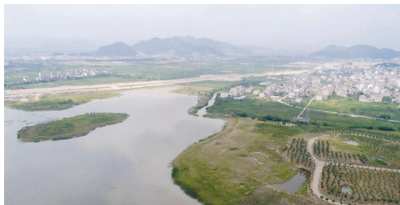
截至目前,飞龙湖表土面积已经剥离380多亩,湖区完成总开挖面的90%,湖区加深部分正在全面施工。建成后,它可以拦蓄绿心范围每年1000万立方米径流量的大部分水量,减轻洪水对城区及周围街道的冲击与影响。
